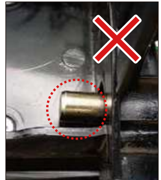
ロックがかかっている状態
