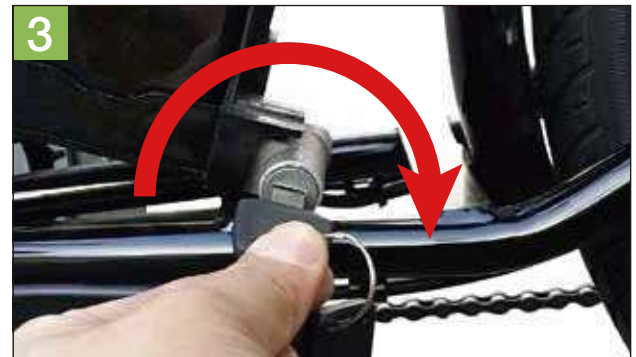
3. バッテリーロックキーを右に回しロックします。
