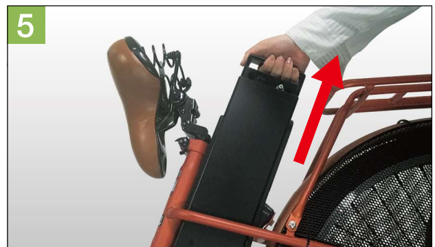
5. バッテリーを上(矢印の方向)に引き上げ取り出します。
