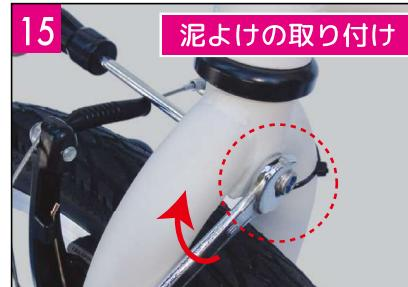
フロントフォークの後側中央のネジとワッシャーを前側のネジを押さえながら取り外してください。
