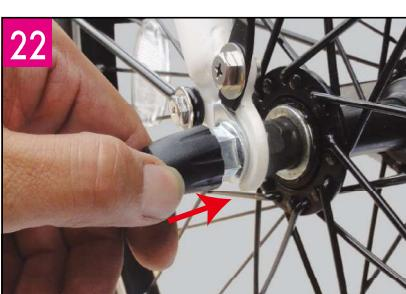
最後に全てのネジを緩みがないように付属のスパナでしっかりと締め、ハブキャップを取り付けて完了です。
