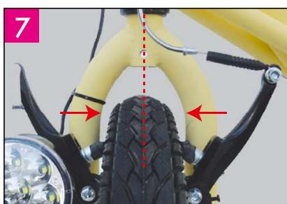
左右のナットは、タイヤがフロントフォークのセンターになるように調整しながらバランスよく締めてください。タイヤがセンターで無かったり、ナットの締まりがゆるいとブレーキは左右対称に握れません。
