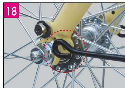
外したフロントフォークのネジの位置に泥よけのステイの穴を合わせてください。
