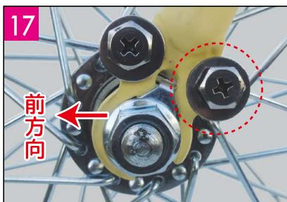
つぎにフロントフォーク両側面のネジとワッシャーを取り外してください。※(上記のネジを外す)
