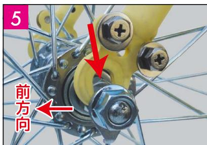
保護キャップを外し、フロントフォークを前輪タイヤの軸(指定箇所)に合わせて奥までしっかりと差し込んでください。
