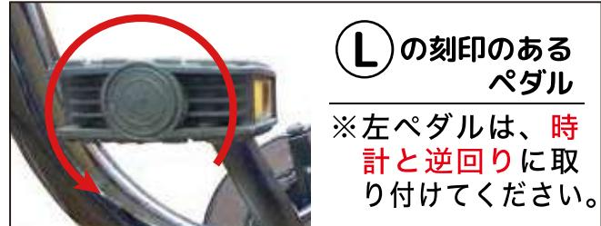
**注意** ペダルが入りにくいときは無理をせずに、再度左右を確認してください。無理矢理ペダルをねじ込んで装着しますと、大変不安定になるだけではなく、クランクのネジ山が削れてペダルが脱落し、大変危険です。また、クランクの修理も不可能になりますので、十分にご注意ください。
