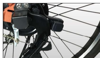
※ロックして鍵を抜いた後、タイヤを少し回してカチッと音がすれば後輪がロック状態となります。
