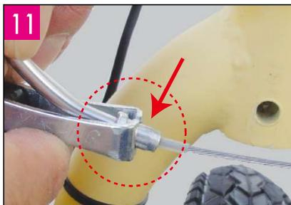
ブレーキワイヤは、フックの溝の部分に引っ掛けてしまりと固定してください。
