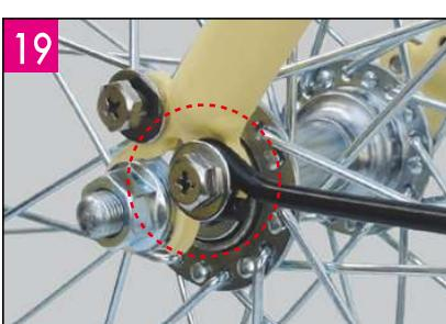
合わせましたら左右の泥よけのステイをワッシャーとネジで軽く締めて取り付けてください。
