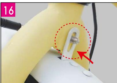
後側から泥よけカバーを差し込み、フックをネジに合わせて、15で外したネジで止めてください。
