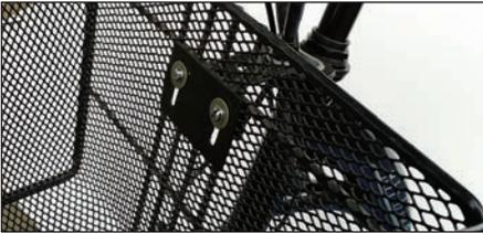
① 前カゴをハンドル前方のステイに沿わせてネジ穴にネジを差し込みます。
