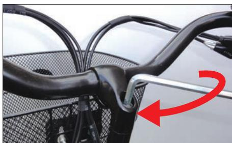
お好みの高さ調整して、六角レンチでステムのボルトをしっかりと締め付けてください。
