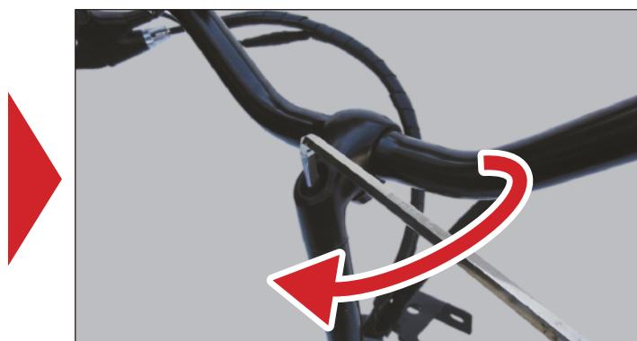
お好みの高さに調整して、六角レンチでステムのボルトをしっかりと締め付けてください。
