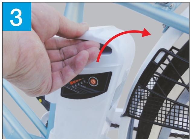
バッテリーの上部をカチッと音がするまで車体側に押して固定してください。
