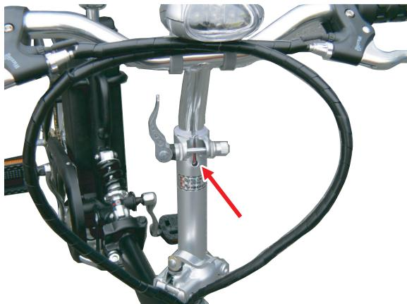
●ロックレバーを締めて、緩い場合はロックレバー調整ネジを締めるように調整してください。
