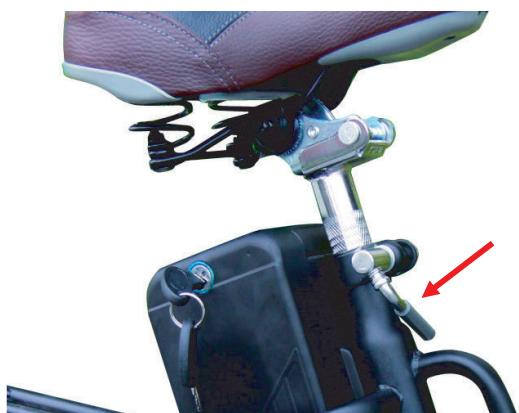
●サドルのパイプ部分を、自転車本体のパイプの穴に差し込んでください。適度な高さに調整し、ロックレバーを締めてください。
