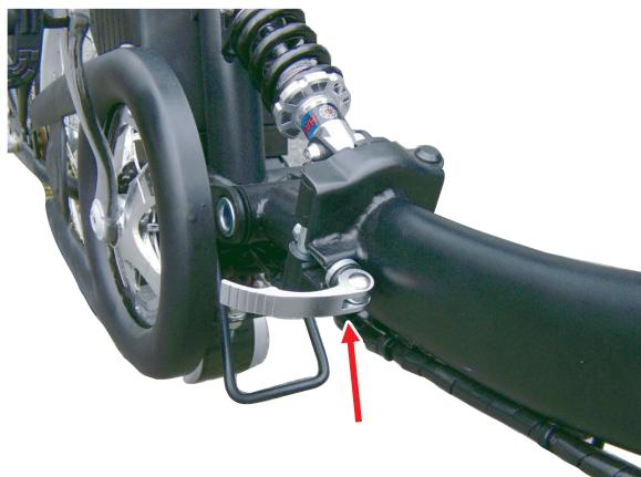
●2つ折りをまっすぐにのばします。その際、ロックレバーを引き上げながらのばして下さい。その後、ロックレバーを締めて完了です。緩いときは反対側のネジを少し締めて調整します。
