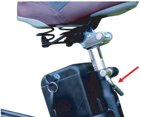
●サドルのパイプ部分を、自転車本体のパイプの穴に差し込んでください。適度な高さに調整し、ロックレバーを締めてください。
