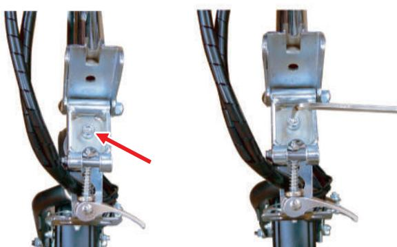
●ハンドルが緩い場合は、接続部分を六角レンチで、ハンドルとタイヤの方向を合わせて締めます。
