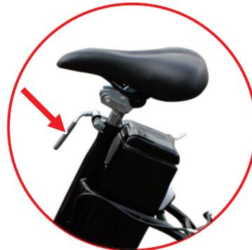
●サドルを差込み、方向をあわせて、高さを調整します。固定レバーで動かないようにしっかりと締め付けます。
