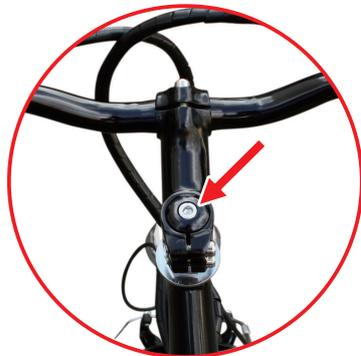
●ハンドルを差込み、方向をあわせて、高さを調整します。六角レンチで動かないようにしっかりと締め付けます。
