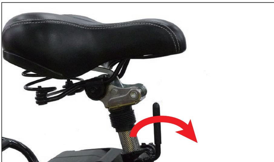
② お好みの高さに調整して、固定レバーでしっかりと締め付けてください。
