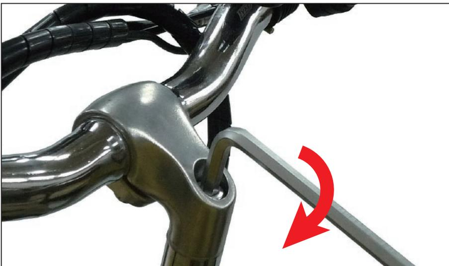
②お好みの高さに調整して、六角レンチでステムのボルトをしっかりと締付けてください。
