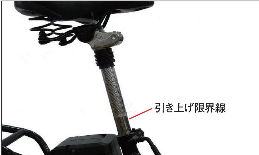
① サドルを差し込み、高さを調整した後固定レバーをしっかりと締め付けてください。
