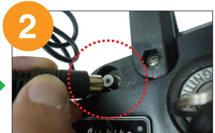
充電ジャックをバッテリーの充電ジャックに差し込み口に差し込みます。
