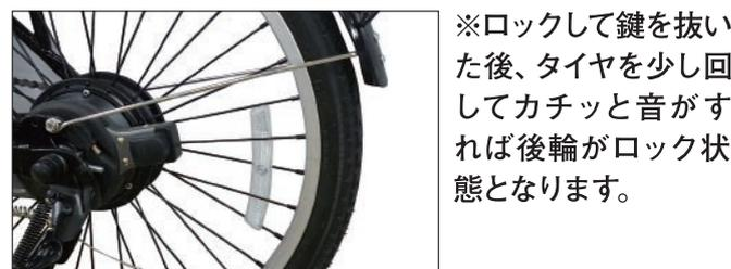
※ロックして鍵を抜いた後、タイヤを少し回してカチッと音がすれば後輪がロック状態となります。
