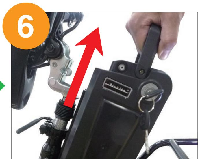
バッテリーを上(矢印の方向)に引き上げ取り出します。
