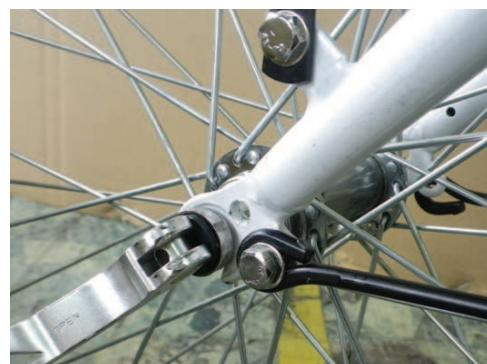
③泥除け部品中ほどのフックとフロントフォークの穴の位置を合わせ、ネジを差し込み軽く締めます。
