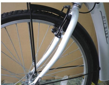
④フロントフォーク前方の、ネジを外した穴と泥除け部品のステイの穴を合わせ、元のネジとワッシャーを取り付けて軽く締めます。
