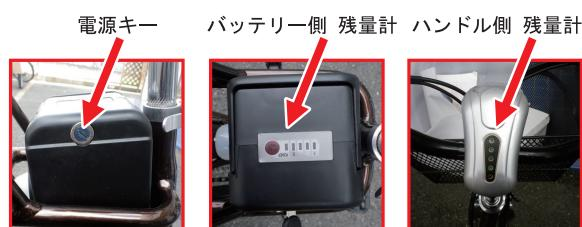
※ハンドル側の残量計は、モーター動作中のバッテリー消耗の目安となります。安全の為、走行中に注視はしないようにして下さい。
