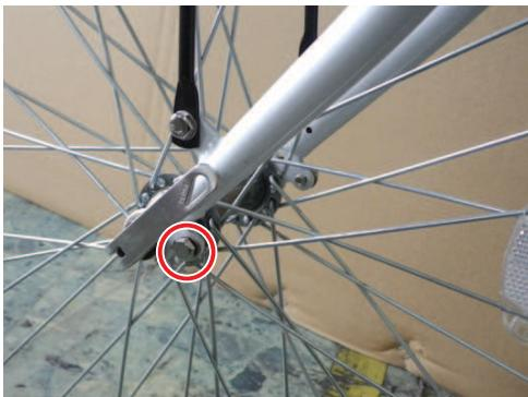
①マルの箇所のネジとワッシャーを外します。
