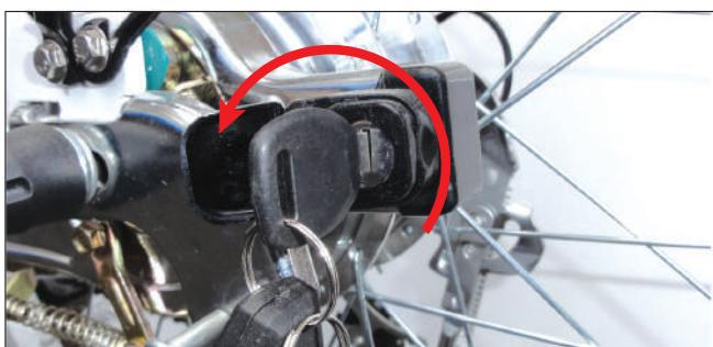
③鍵穴に鍵を差し込んで反時計回りに回すとロックします。時計回り(右)…開錠／反時計回り(左)…施錠
