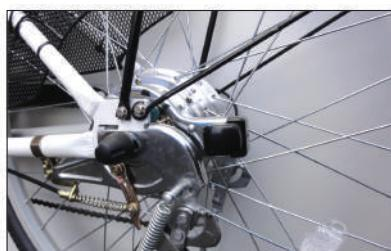
※ロックして鍵を抜いた後、タイヤを少し回してカチッと音がすれば後輪がロック状態となります。
