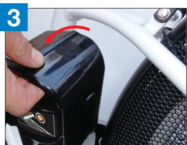
ロックが解除しましたら、バッテリーの上部取っ手を手前に倒し、上側に引き出してください。
