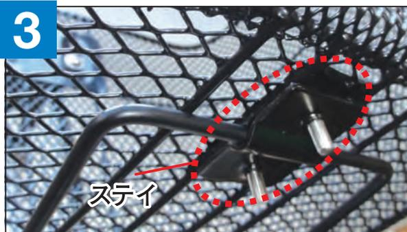
③ 底部を固定する板ナットの溝と、ステイを合わせてカゴの上からネジを差し込み、軽く締めて固定します。最後に各部のネジをしっかりと締め付けてください。
