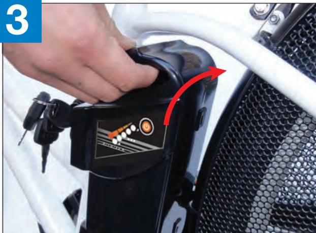
バッテリーの上部をカチッと音がするまで車体側に押しつけて固定してください。
