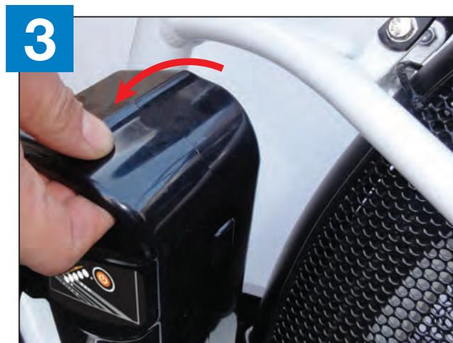
ロックが解除しましたら、バッテリーの上部取っ手を手前に倒し、上側に引き出してください。
