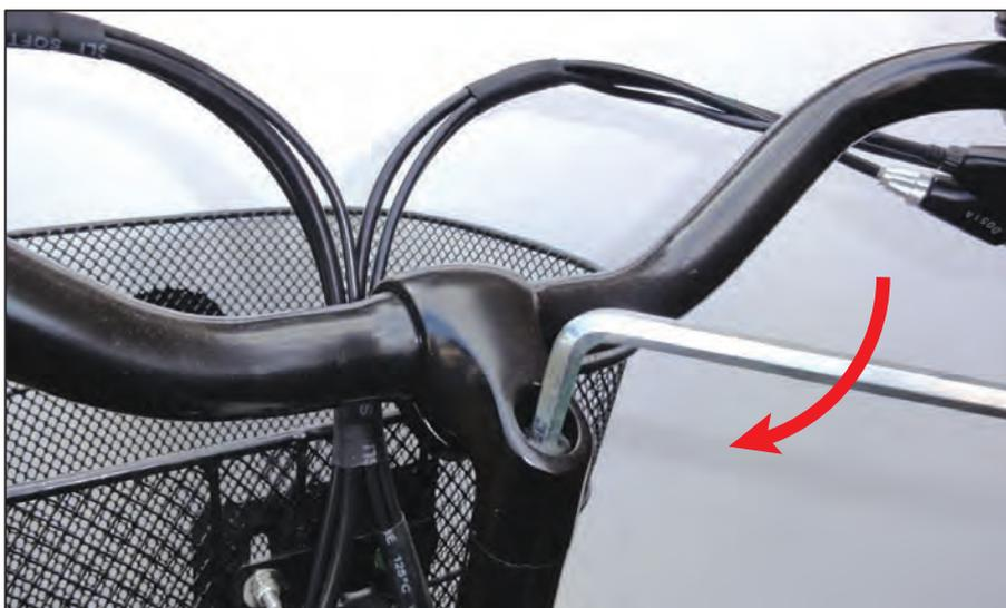
②お好みの高さに調整して、六角レンチでステムのボルトをしっかりと締め付けてください。
