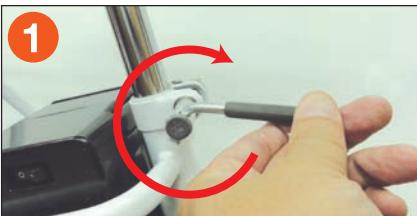
サドルレバーを回してゆるめ、サドルを差し込み、高さや左右を調整してください。
