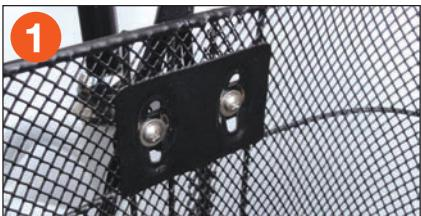
前カゴをハンドル前方のステイに沿わせてネジ穴にネジを差し込みます。
