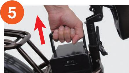
バッテリーを上(矢印の方向)に引き上げ取り出します
