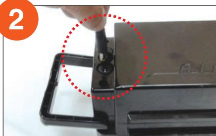
充電ジャックをバッテリーの充電ジャック差し込み口に差し込みます。
