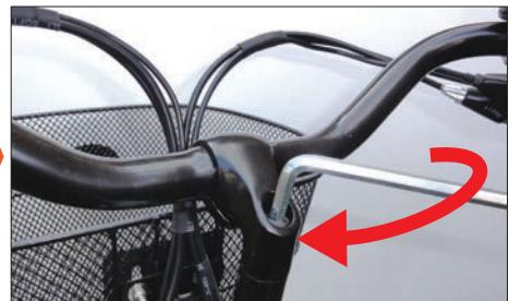
お好みの高さに調整して、六角レンチでステムのボルトをしっかりと締め付けてください。
