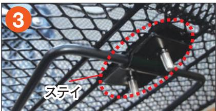
底部を固定する板ナットの溝と、ステイを合わせてカゴの上からネジを差し込み、軽く締めて固定します。最後に各部のネジをしっかりと締め付けてください。
