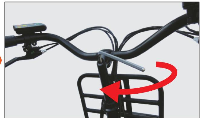
お好みの高さに調整して、六角レンチでシステムのボルトをしっかりと締め付けてください。
