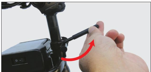
サドルの高さ・向きが決まりましたら、サドル固定レバーを時計回りに回して、しっかりと締め付けてください。サドルが上下左右に動かないことを確認し、固定しましたらサドル固定レバーを折り畳んでください。
