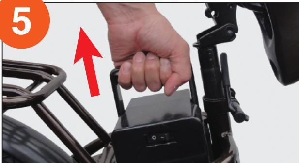
バッテリーを上(矢印の方向)に引き上げ取り出します。
