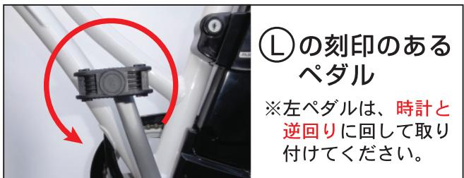
**注 意** ペダルが入りにくいときは無理をせずに、再度左右を確認してください。無理矢理ペダルをねじ込んで装着しますと、大変不安定になるだけではなく、クランクのネジ山が削れてペダルが脱落し、大変危険です。また、クランクの修理も不可能になりますので、十分にご注意ください。※ペダルの取り付け不良による故障は、初期不良期間中（お届け日から8日間）でも有償での修理となります。
