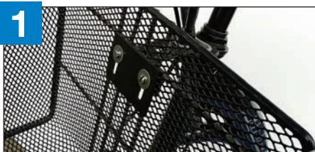
前カゴをハンドル前方のステイに沿わせてネジ穴にネジを差し込みます。
