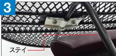
底部を固定する板ナットの溝と、ステイを合わせてカゴの上からネジを差し込み、軽く締めて固定します。
