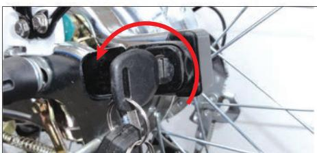
③鍵穴に鍵を差し込んで反時計回りに回すとロックします。時計回り(右)…開錠／反時計回り(左)…施錠
