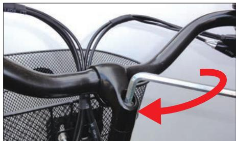
お好みの高さに調整して、六角レンチでステムのボルトをしっかりと締め付けてください。
