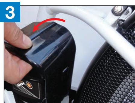
ロックが解除しましたら、バッテリーの上部取手を手前に倒し、上側に引き出してください。
