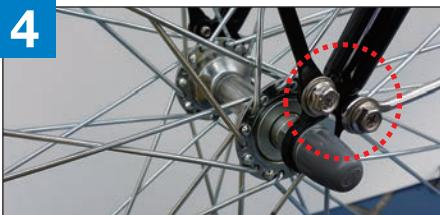
カゴを取り付けたあと、各部のネジをしっかりと締め付けて固定してください。**注)** 特に、フロントフォークネジ穴とカゴステイの固定部分はしっかりと締め付けてください。
