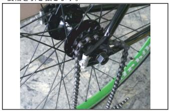
⑤再度後輪を取り付け、チェーンをギアクランクに 添わせながら取り付けます。
