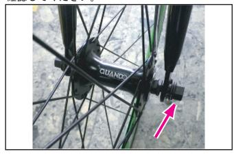
⑤ブレーキの位置を調整して、前輪の取り付け 完了です。
