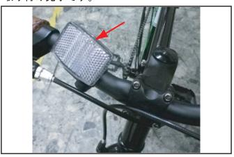
②ハンドルステムにハンドルと前面の部品を セットして、元通りにネジで止めてください。
